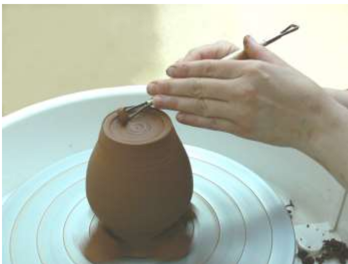
Рис.12:2.Обтачивание. Положение рук и пальцев.
